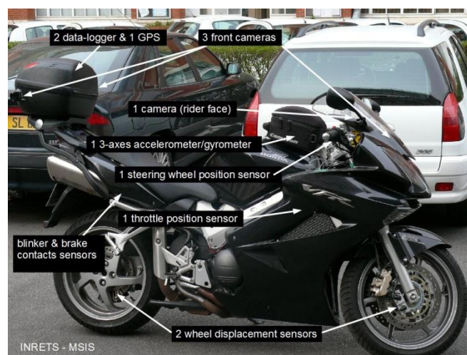
Abbildung 3: Beispiel der Instrumentierung eines Motorrads
