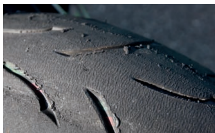
Zu geringes Profil gefährdet die Verkehrssicherheit von Motorrädern in hohem Maße.
