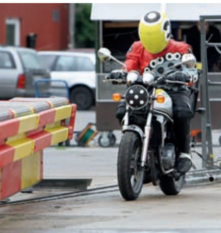
Crashtest von DEKRA zur Optimierung von Schutzplankensystemen.
