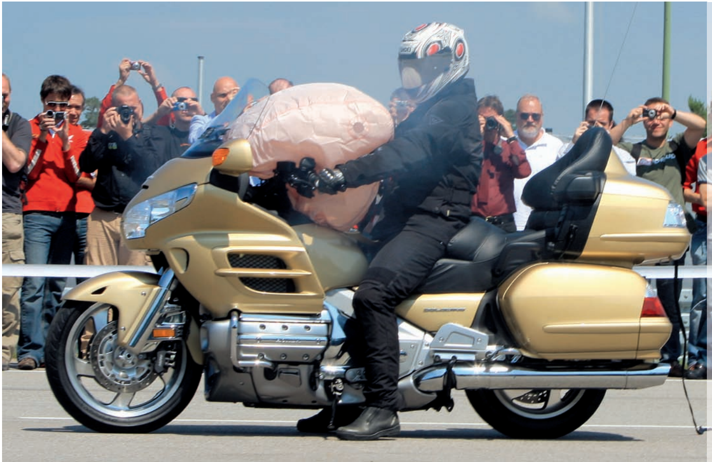
Die Gold Wing von Honda war 2006 das erste Motorrad mit serienmäßigem Airbag.
