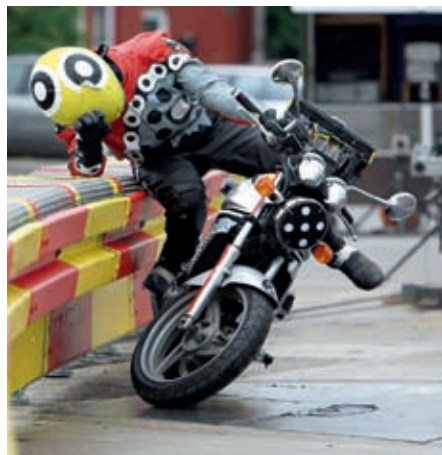
Crashtest von DEKRA zur Optimierung von Schutzplankensystemen.
