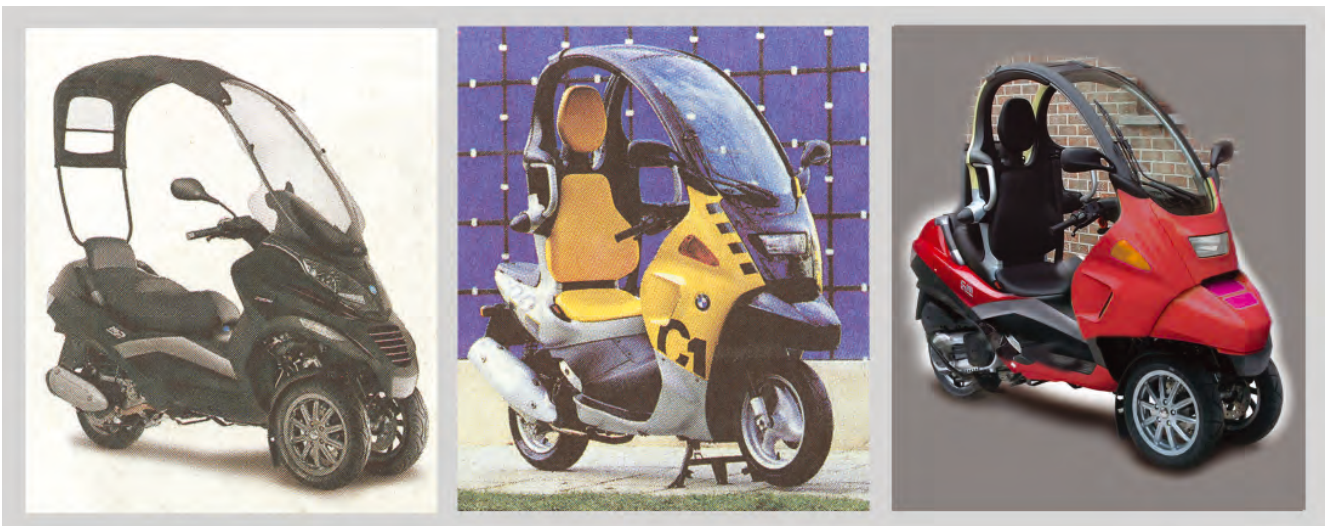
Abbildung 8: Denkmodell zur Erhöhung der Sicherheit von motorisierten Zweirädern (rechts) abgeleitet aus bereits realisierten Fahrzeugen Quellen: Piaggio (links), BMW (Mitte), UDV (rechts)
